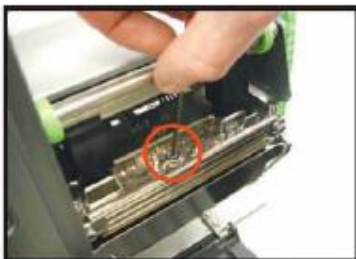
2. Отвинтите винт крепления головки
