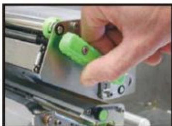
1. Откройте рычаг открытия головки.
