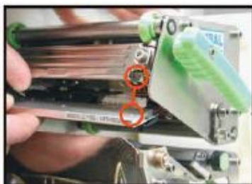
5. Вставьте новую головку так, чтобы цилиндрический выступ вошел в отверстие в печатающей головке.
