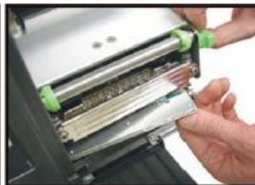
3. Одновременно с выниманием головки, держите рычаг головки в открытом положении.
