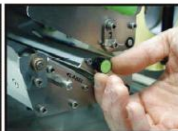
3. Поверните регулировочное колесо для считывания конца этикетки.
