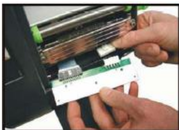
4. Снимите с головки два разъема и замените головку.
